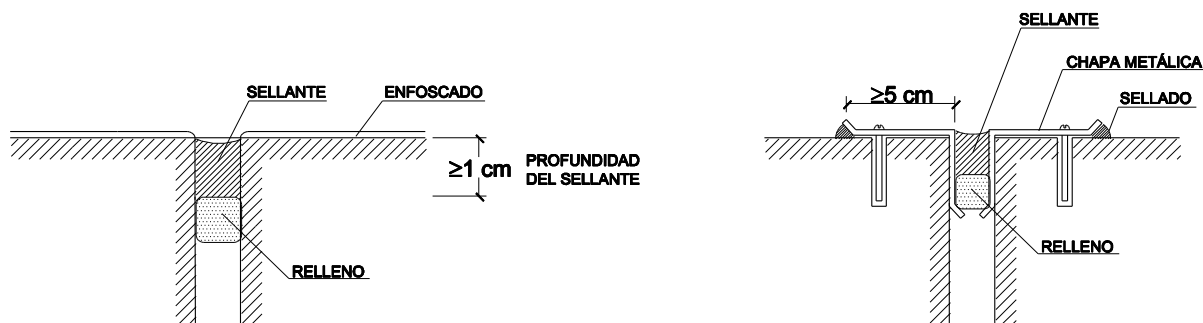
Figura 2.6 Ejemplos de juntas de dilatación
